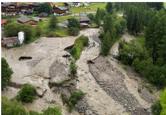
Schäden im Mündungsbereich nach dem Hochwasser vom Juni/Juli 2024. Im Bereich der vorgezogenen Massnahmen 2023 wurden keine grossen Schäden beobachtet.
